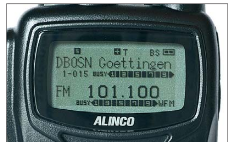
Bild 7: Zur besseren Übersicht lassen sich Speicherfrequenzen alphanumerisch benennen.
