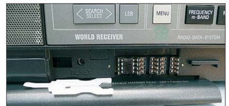
Bild 25: Originell – Senderspeicherung auf austauschbaren und im Gerät kopierbaren EEPROMs beim Satellit 700
