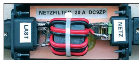
Bild 6: Robustes Eigenbaunetzfilter mit zwei Ringkernen für eine Strombelastbarkeit von I_N = 20 A Fotos: Werkfotos (2), DC9ZP (3)
