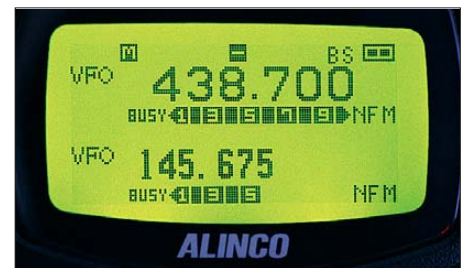
Bild 2: Das hintergrundbeleuchtete LC-Display zeigt übersichtlich die zentralen Parameter beider VFOs.
