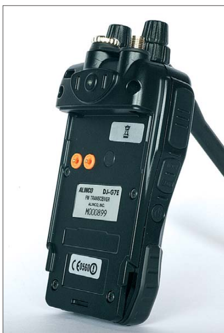
Bild 3: Alternativ zum mitgelieferten Akkumulator lässt sich auf der Rückseite des DJ-G7E ein als Zubehör erhältliches Batteriegehäuse anstecken.
